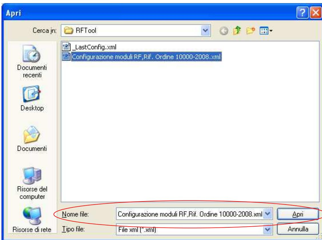
5. Selezionare il file di configurazione desiderato e premere su "Apri"; verranno in automatico caricati i parametri di configurazione salvati nel file.
