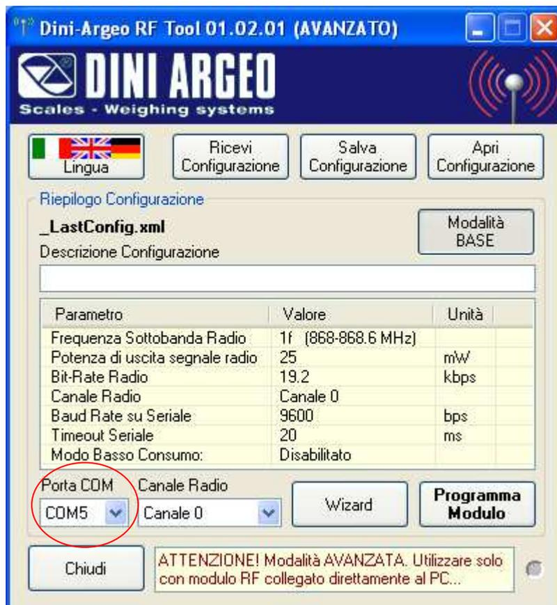
4. Selezionare la "Porta Seriale" del PC al quale è collegato il modulo radio o l'indicatore:
