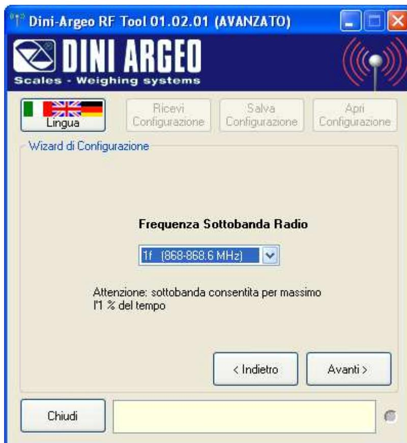
La banda radio, ovvero l'intervallo di frequenze selezionabili, va da 868 a 870Mhz; viene suddivisa in 9 sottobande che determinano specifiche limitazioni in termini di potenza massima e spaziatura tra i canali (frequenze di lavoro):
