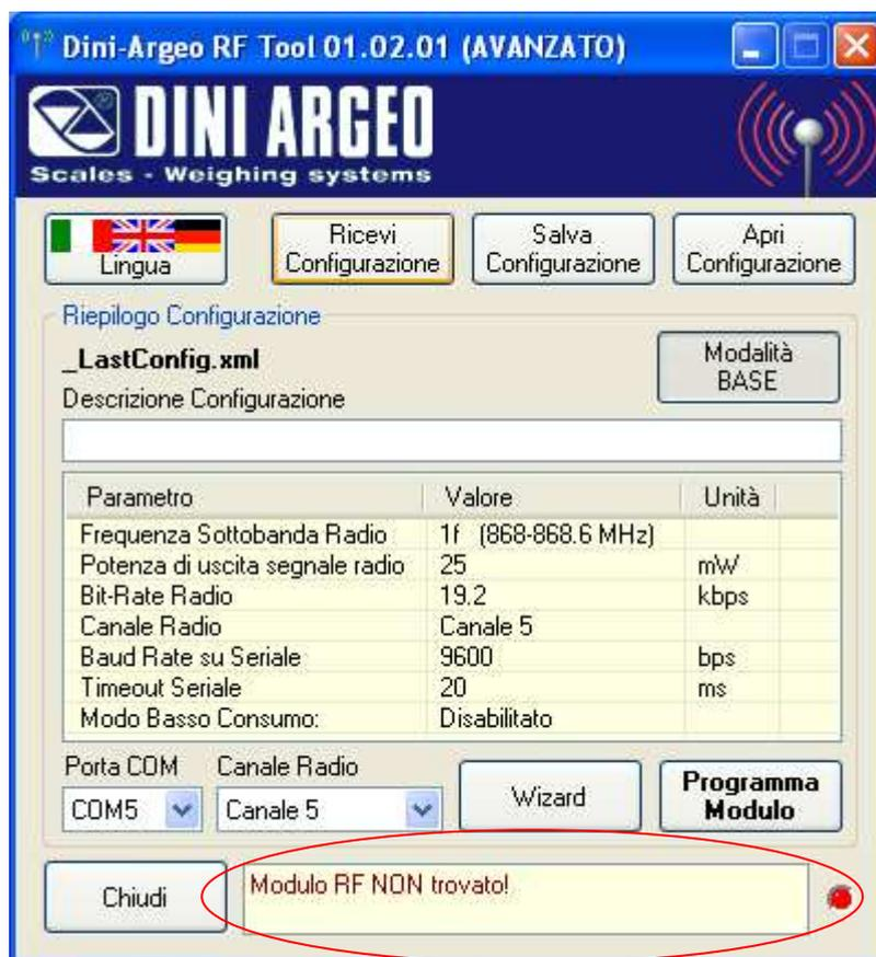
In tal caso occorrerà controllare i collegamenti e verificare il funzionamento della seriale, dopodichè riprovare.
