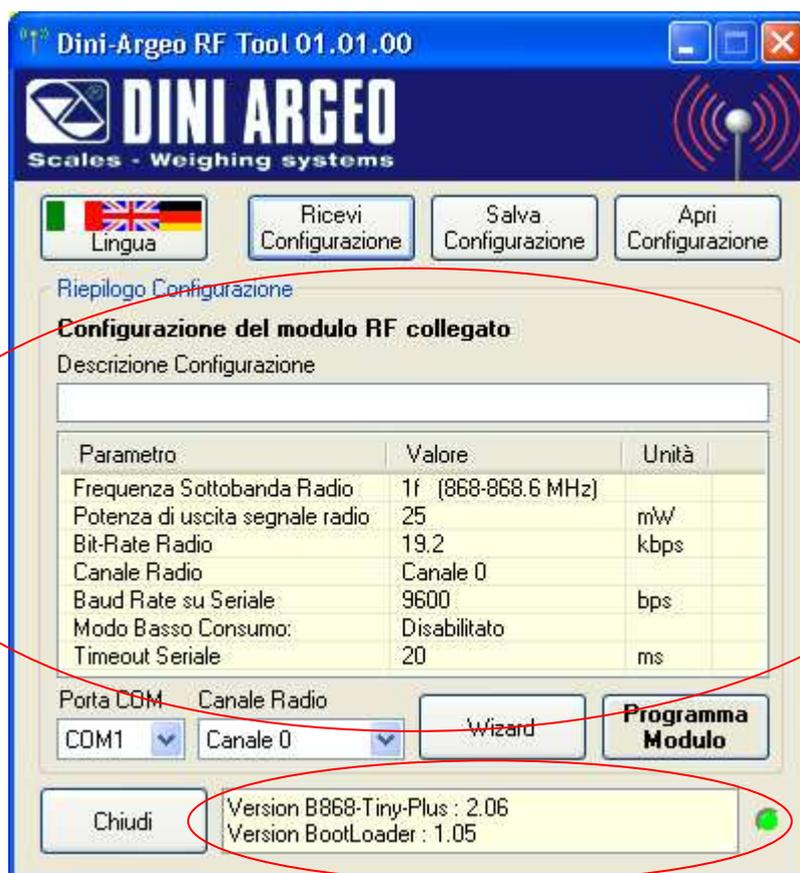
Verranno in automatico caricati i parametri di configurazione del modulo e la versione del firmware e loader.
