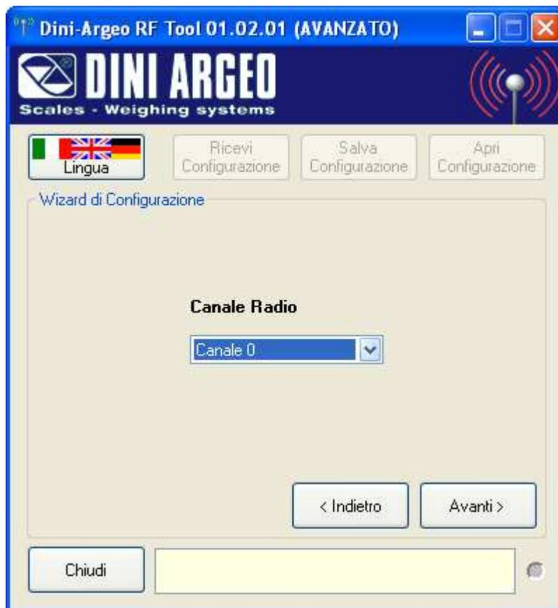
I Canali Radio selezionabili variano a seconda del Bit-Rate Radio e dalla Sottobanda radio impostati precedentemente:
