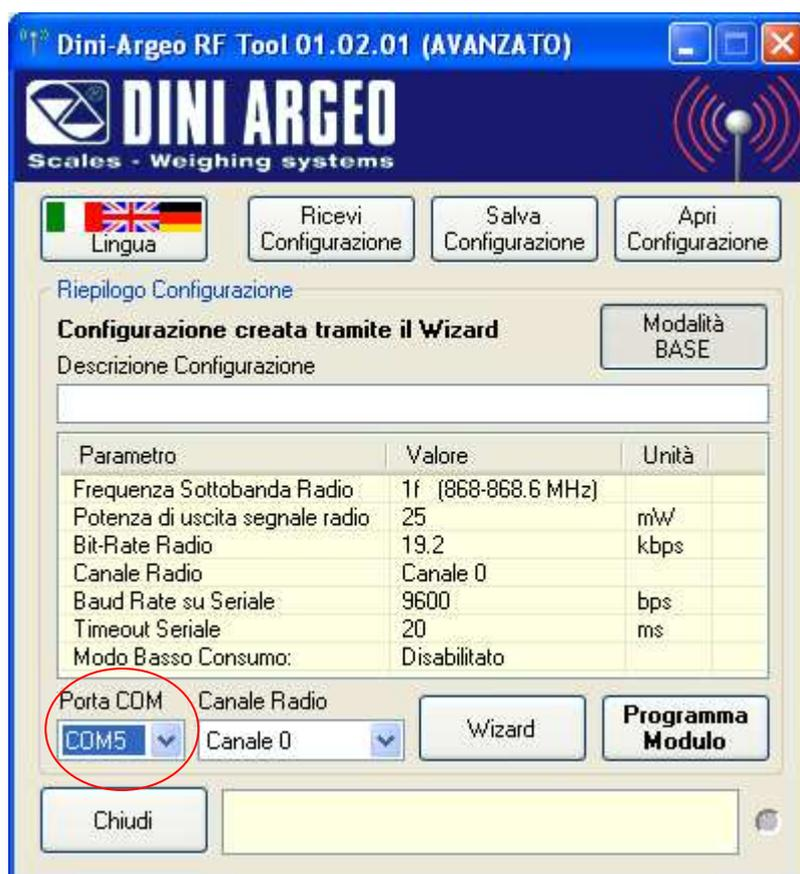
2. Selezionare la "Porta Seriale" del PC al quale è collegato il modulo radio o l'indicatore:
