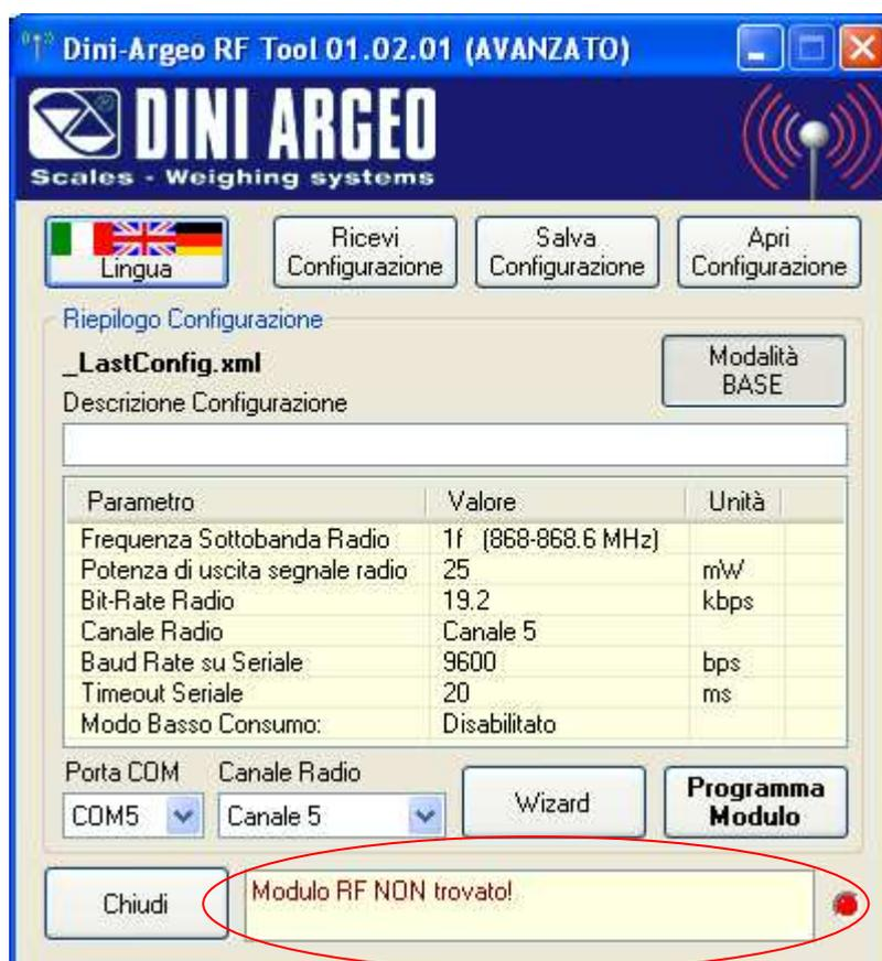
se la comunicazione non è corretta e la programmazione non è andata a buon fine (occorre controllare i collegamenti e verificare il funzionamento della seriale).
