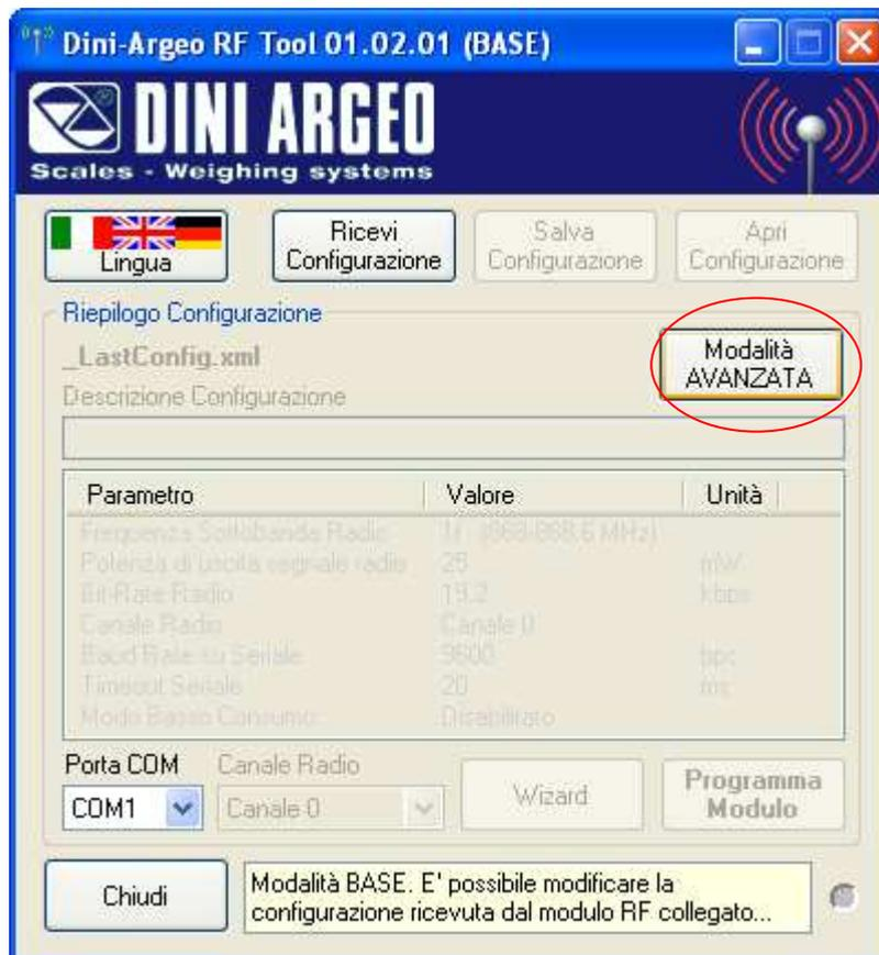
3. Selezionare la modalità di configurazione (vedere paragrafo 7); nel caso in cui sia selezionata la modalità base occorre ricevere la configurazione dal modulo (vedere paragrafo 11) per abilitare i controlli di configurazione e programmazione.
