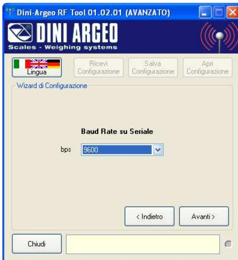
Il Baud-Rate massimo consentito sulla porta seriale dipende dal Bit-Rate Radio impostato precedentemente:
