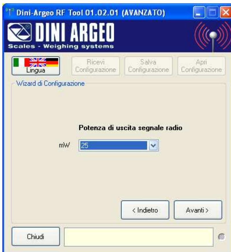
La Potenza di Uscita Segnale Radio determina la distanza massima di comunicazione tra i moduli dello stesso gruppo: più alto è il valore, più elevata è la distanza che si può ottenere.
